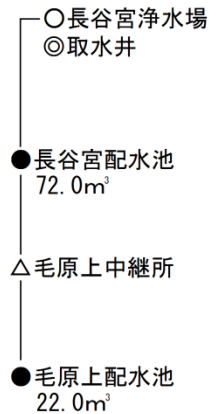
図4 水道施設概略図（美里簡水・毛原簡水・長谷宮簡水）
