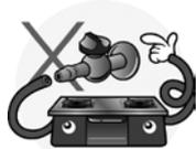
● ガスコンロやガスストーブを壁や柱の近くに取り付けると、表面は熱に強い材料で覆っていても、長年に渡る使用で内部の木材が炭化して、発火に至ることがあります。壁や柱からは間隔を取り、防熱板を設置した場所に取り付けてください。
