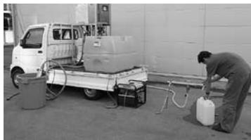
本町でも、昨年からの防災プロジェクトチームを立ち上げ、住民の皆様方の安全・安心を最重要課題に、防災施策の一環として本機2台を導入しました。造水機は、停電時も想定し発電機付きで、ポンプで吸い上げた原水を高性能膜モジュールに通し、水道水と同濃度の殺菌用塩素を自動注入し、ミクロのレベルの汚れや雑菌を取り除き、飲料水として適するレベルに浄化するものです。導入機は1時間で1台当たり2000リットルの飲料水をつくる能力があり、24時間フル稼働した場合、5万リットルの水が浄化できます。また、造水機・発電機・給水タンク・水栓スタンドを軽トラックの荷台に積んで運べるため、移動や保管も容易です。こうした機器を使用しないですめばいいのですが、万が一のため当町でもこうした備えをおこなっています。
