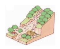
谷や斜面に溜まった土・石・砂 などが、大雨による水とともに一 気に流れ出す現象。スピードが速 く、破壊力も大きいため、広範囲 に大きな被害が出る。
