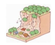
地中にしみ込んだ雨水で柔らか くなった土砂が斜面から突然崩れ 落ちる現象。一瞬のうちに崩れ落 ちるので、逃げ遅れなどで被害が 大きくなる。
